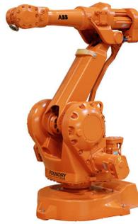
Fotografia 1: Robô esférico ABB modelo IRB 2400
